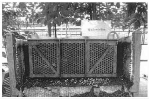
防水層の耐根性試験
