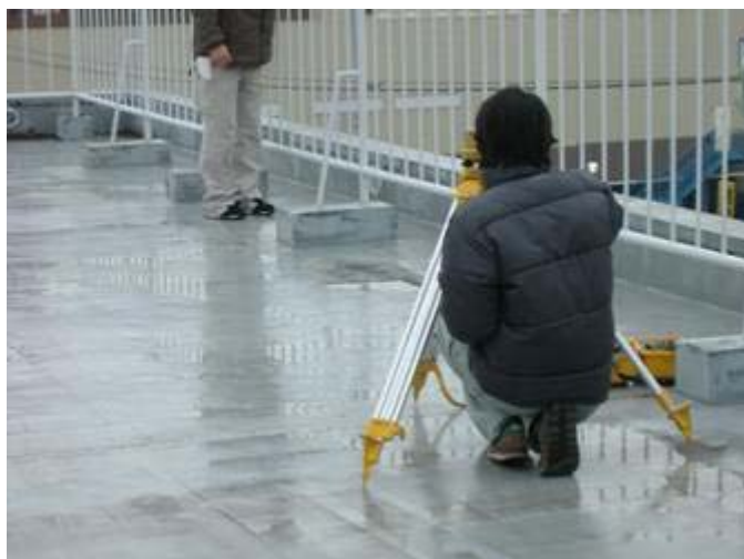
防水層に直置きの水準器
