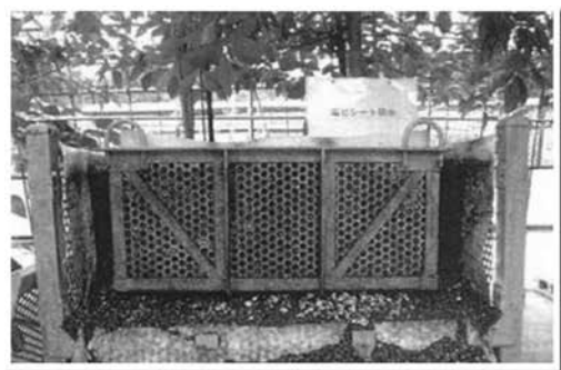
防水層の耐根性試験
