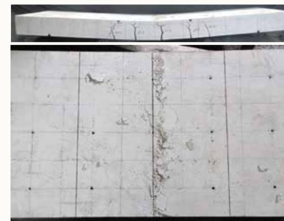
写真-5 ビス穴@200mm試験体の破壊状況(上:側面 下:平面)
