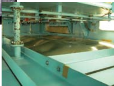
大型試験機を用いた昇圧と脈動試験
