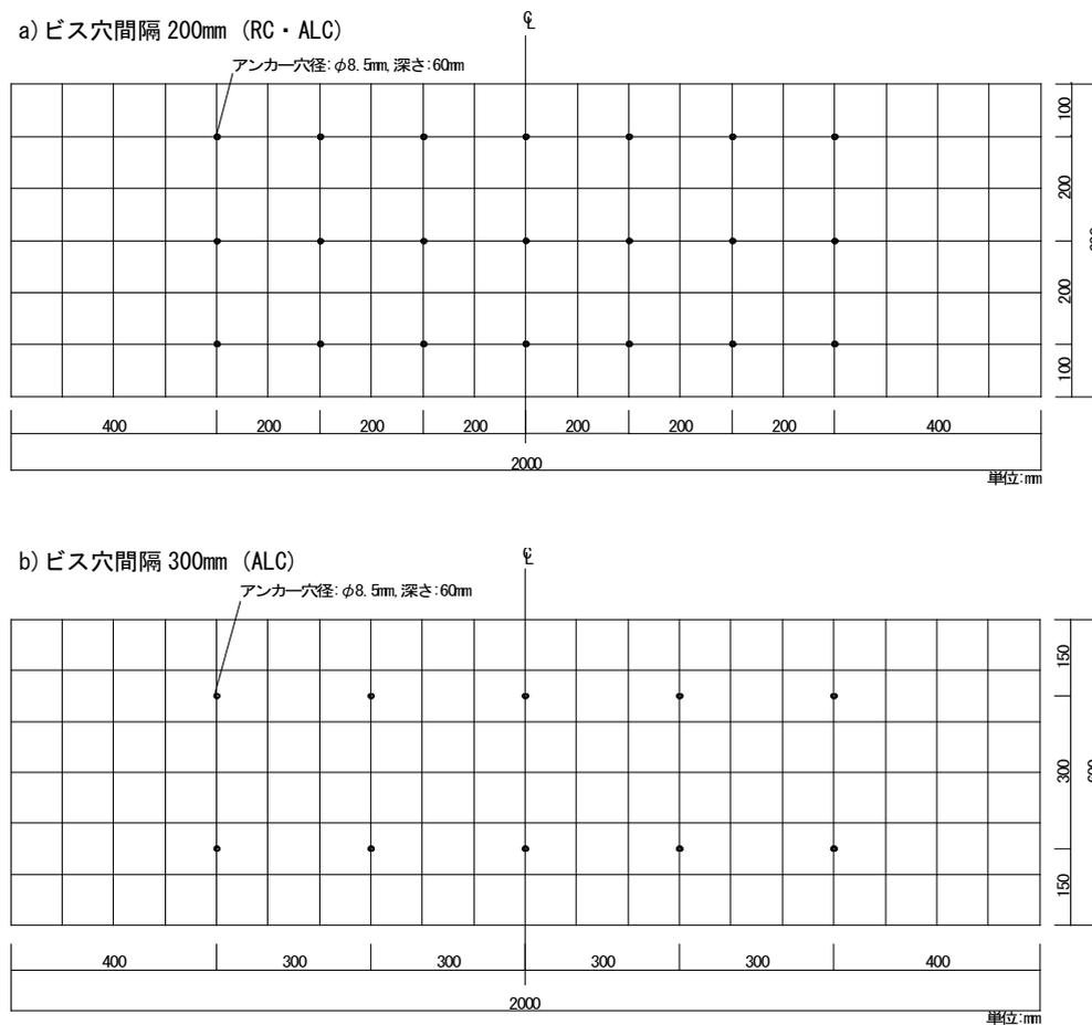
図-2 固定用アンカービス穴位置
