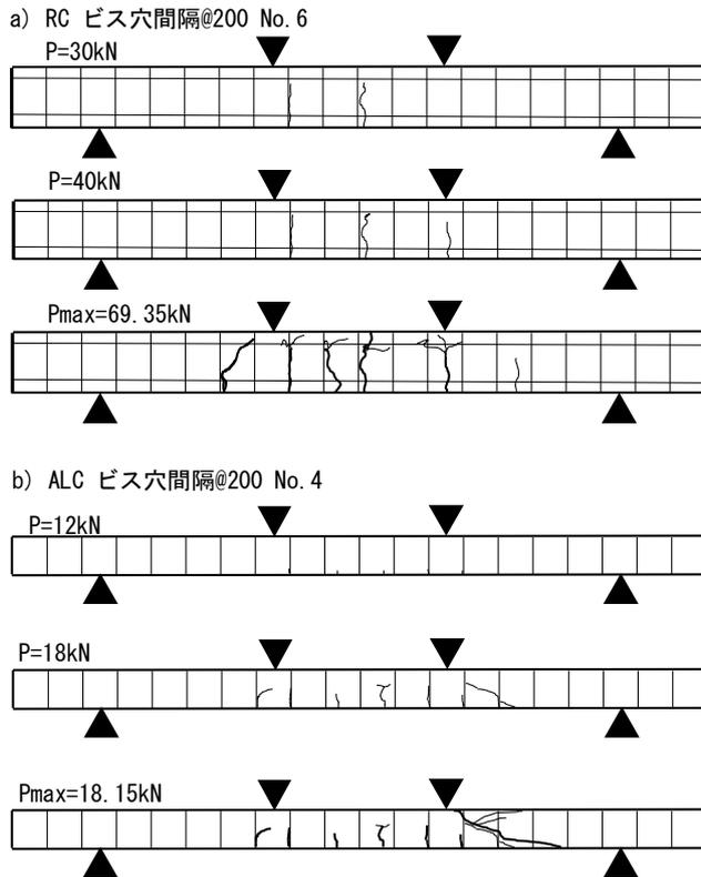
図-4 曲げひび割れの進展状況
