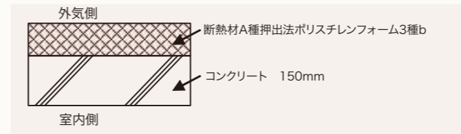
図-2 断熱材断面構成
